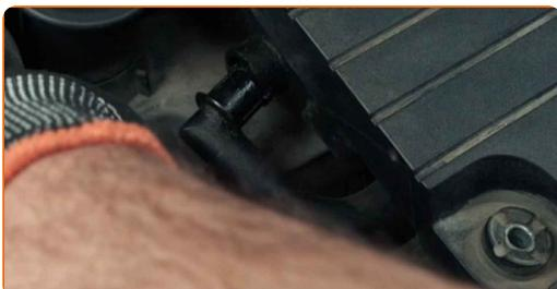
5 Odstranite cev za dovod zraka.
