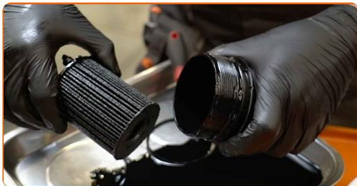
**21** Očistite pokrov ohišja oljnega filtra. Uporabite večnamenski čistilni sprej.
