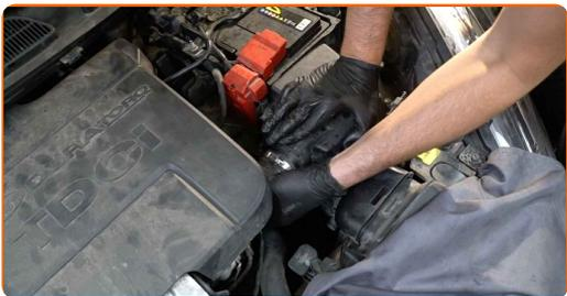
**34** Pritrdite vpenjalni kos na cev za dovod zraka. Uporabite nasadni ključ N°7. Uporabite izvijač z zatikalom.
