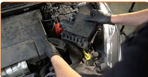
**33** Namestite cev za dovod zraka in jo pričvrstite.
