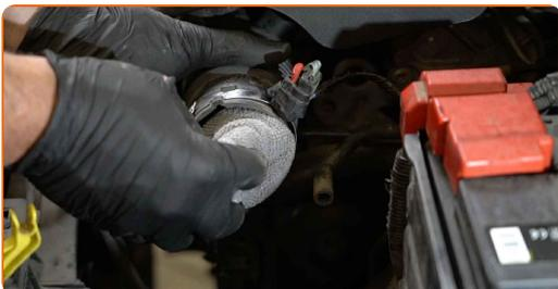
**15** Pripravite posodo za stari oljni filter.
