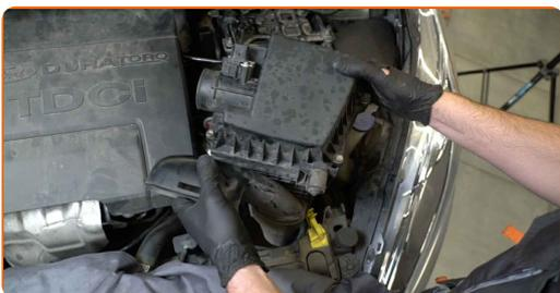
**14** Pokrijte cev za dovod zraka s krpo iz mikrovlaken, da preprečite vnos prahu in umazanije v sistem.
