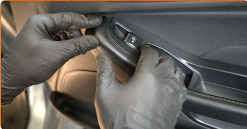
**30** Privijte pritrdilne elemente vratne kljuke. Uporabite vijačni nastavek T20. Uporabite izvijač z zatikalom.
