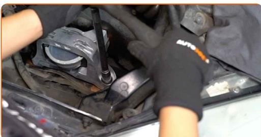
**15** Privijte zgornji pritrdilni element nosilca motorja. Uporabite nasadni ključ №16. Uporabite izvijač z zatikalom.
