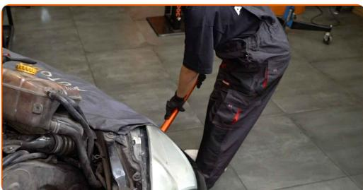
**14** Privijte pritrdilne elemente, ki povezujejo nosilec motorja s karoserijo. Uporabite nasadni ključ №16. Uporabite izvijač z zatikalom.
