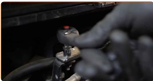
**5** Očistite pritrdilne elemente cevi za dovod goriva. Uporabite večnamenski čistilni sprej.
