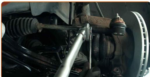
**18** Obdelajte pritrdilni element, ki povezuje glavo jarmovega droga s premnikom. Uporabite bakreno mast.
