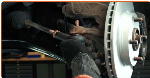
**16** Zategnite pritrdilno matico, ki povezuje glavo jarmovega droga s premnikom. Uporabite nasadni ključ №17. Uporabite navorni ključ. Zategnite ga do navora 48 Nm.
