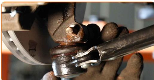
55 Privijte pritrdilne elemente nosilnega zgiba. Uporabite nasadni ključ №15. Uporabite vijačni nastavek T50. Uporabite izvijač z zatikalom.
