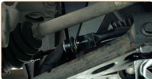
**15** Zategnite pritrdilni element veznega elementa stabilizatorja. Uporabite kombinirani ključ №17 (2 kosa).
