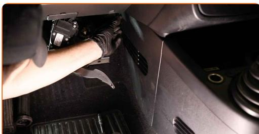
**12** Vrnite pedal za plin v prvoten položaj in privijte njegov pritrdilni element. Uporabite nasadni ključ №10. Uporabite izvijač z zatikalom.
