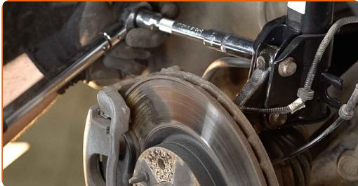
**36** Obdelajte vse spoje opornika stabilizatorja. Uporabite sprej WD-40.
