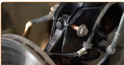
**35** Pritrdite spodnje pritrdilne elemente, ki povezujejo blažilnik in premnik. Uporabite nasadni ključ №15. Uporabite nasadni ključ №17. Uporabite kombinirani ključ №15. Uporabite navorni ključ. Zategnite ga do navora 70 Nm.
