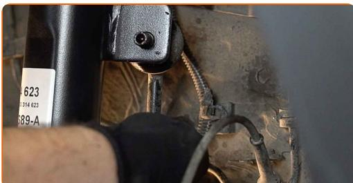
**38** Zategnite pritrdilni element, ki povezuje jarmov drog na blažilnik. Uporabite kombinirani ključ №17. Uporabite navorni ključ. Zategnite ga do navora 55 Nm.
