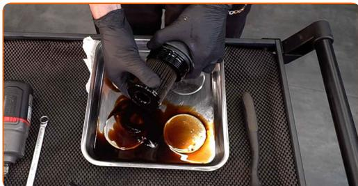
**16** Očistite pokrov ohišja oljnega filtra. Uporabite večnamenski čistilni sprej.
