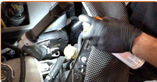
**11** Odvijte ohišje pokrova filtra skupaj s starim elementom filtra. Uporabite nasadni ključ N°27. Uporabite izvijač z zatikalom.
