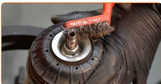
**27** Odstranite matico oporne batnice. Uporabite imbus št. H6. Uporabite nasadni ključ №18. Uporabite izvijač z zatikalom.
