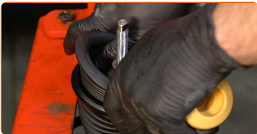
**35** Namestite zgornji nosilec opornika in ležaj nosilca opornika.
