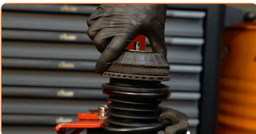
**36** Zategnite matico amortizerja. Uporabite imbus št. H8. Uporabite nasadni ključ №17. Uporabite navorni ključ. Zategnite ga do navora 44 Nm.
