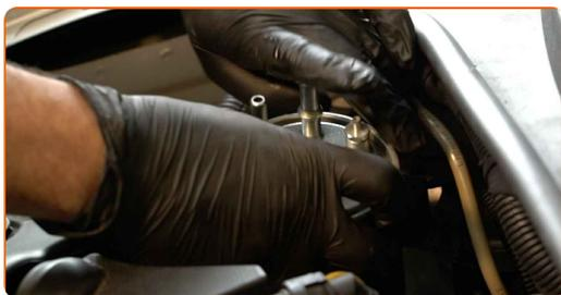
**7** Odstranite priključek senzorja za tlak goriva.
