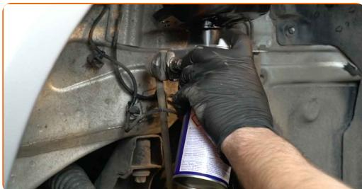
7 Odvijte pritrdilni element, ki povezuje jarmov drog na blažilnik. Uporabite kombinirani ključ №15. Uporabite imbus št. H5. Uporabite izvijač z zatikalom.
