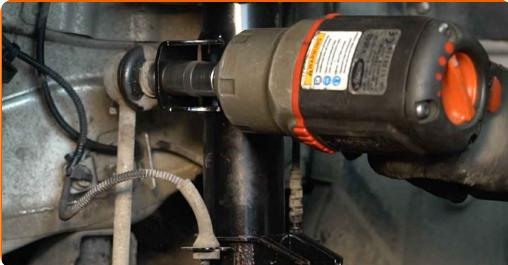
8 Sprostite pritrdilne elemente, ki povezejo drog/opornik stabilizatorja na palico stabilizatorja. Uporabite nasadni ključ №15. Uporabite izvijač z zatikalom.
