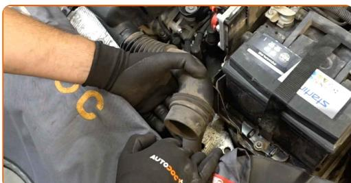
4 Odstranite pritrdilne vijke pokrova zračnega filtra. Uporabite nasadni ključ №10. Uporabite izvijač z zatikalom.
