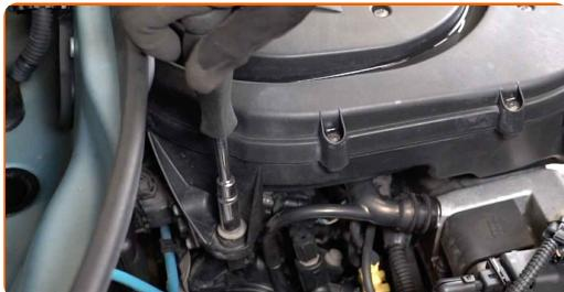
4 Odstranite zadrževalno vzmet ohišja zračnega filtra.
