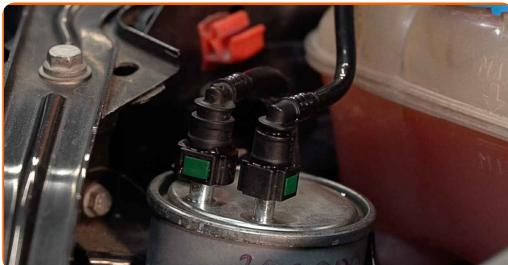
**4** Stisnite sponke in odstranite cevi za dovod goriva iz ohišja filtra za gorivo. Uporabite klešče za cevi za gorivo.
