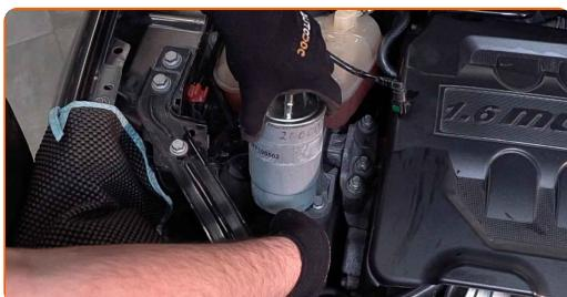
**7** Odstranite priključek senzorja za tlak goriva.
