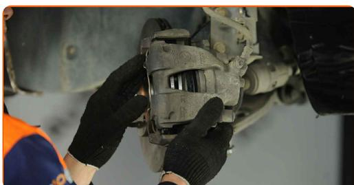
**39.2** Zategnite pritrdilne elemente nosilca zavornega sedla. Uporabite nasadni ključ №12.
