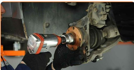
**13** Odvijte končno pritrdilno matico na volanskem členku. Uporabite nasadni ključ №17. Uporabite izvijač z zatikalom.
