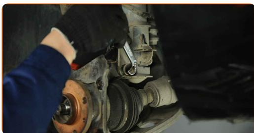
**34** Namestite ABS senzor na volanskem členku in ga pritrdite. Uporabite nasadni ključ №10.
