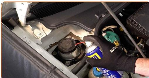
**4** Sprostite zgornji pritrtilni element sedeža za namestitev blažilnika. Uporabite nasadni ključ №13. Uporabite izvijač z zatikalom.
