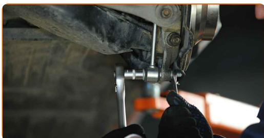
**15** Zategnite pritrdilni element, ki povezuje jarmov drog na palico stabilizatorja. Uporabite kombinirani ključ №16. Uporabite kombinirani ključ №22. Uporabite navorni ključ. Zategnite ga do navora 50 Nm.
