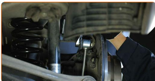
**16** Obdelajte vse spoje opornika stabilizatorja. Uporabite bakreno mast.
