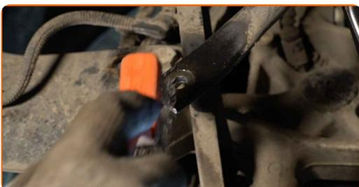
**12** Namestite prečno povezavo stabilizatorja.
