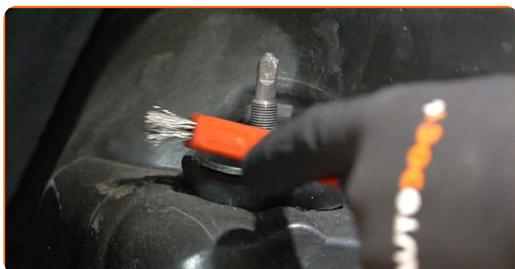
**10** Odvijte zgodnjo pritrditev amortizerja. Uporabite kombinirani ključ №17. Uporabite nasadni ključ za blažilnik št. DD6. Uporabite izvijač z zatikalom.
