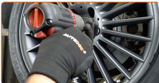
**33** Spustite avto in z delanjem v navzkrižnem vrstnem redu, zategnite kolesne vijake. Uporabite kolesni nasadni nastavek št. 17 Uporabite navorni ključ. Zategnite ga do navora 130 Nm.
