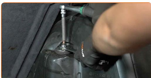
**36** Obdelajte pritrdilne elemente amortizerja. Uporabite bakreno mast.
