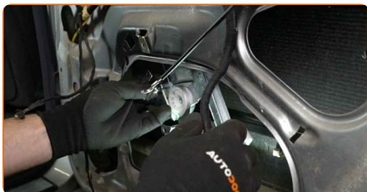
**30** Namestite zakovice mehanizma regulatorja okna. Uporabite orodje za kovičenje. Uporabite 4,8 mm zakovice.
