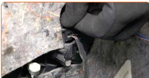
**47** Pritrdite kabel aktuatorja vratne ključavnice.
