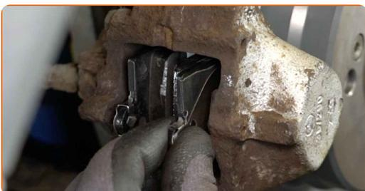
**18** Namestite zadrževalno vzmet zavornih ploščic.
