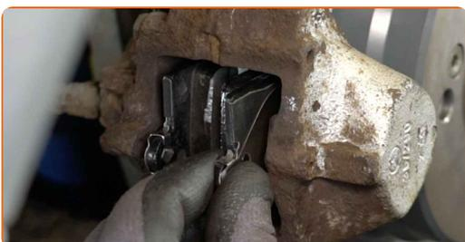
**35** Namestite zadrževalno vzmet zavornih ploščic.
