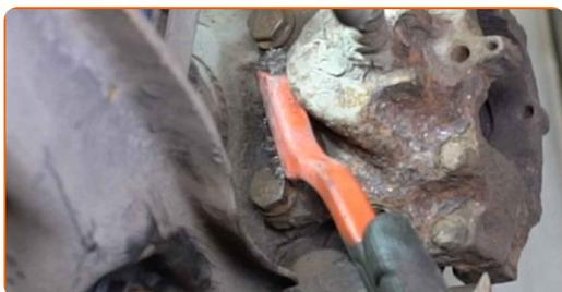
**14** Odvijte pritrdilne elemente zavornega sedla. Uporabite nasadni ključ №16. Uporabite izvijač z zatikalom.
