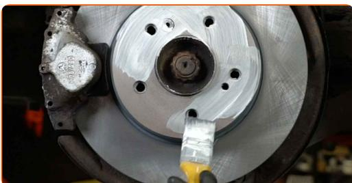
**38** Očistite površino zavornih kolutov. Uporabite čistilo zavor.
