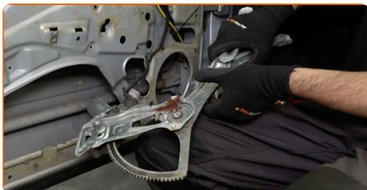
**28** Odklopite konektor z motorja električnega okna.
