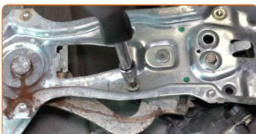
**30** Odstranite motor električnega okna.
