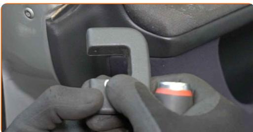
**10** Odvijte pritrdilne elemente vratnega panela. Uporabite Phillips križni izvijač.
