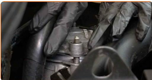
**25** Zategnite pritrdilne elemente pokrovčka ohišja oljnega filtra. Uporabite nasadni ključ №13. Uporabite navorni ključ. Zategnite ga do navora 25 Nm.
