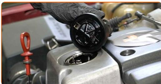
**5** Očistite pokrov ohišja oljnega filtra. Uporabite večnamenski čistilni sprej.
