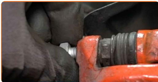
**22** Zategnite pritrdilne elemente zavorne čeljusti. Uporabite kombinirani ključ №15. Uporabite nasadni ključ №13. Uporabite navorni ključ. Zategnite ga do navora 35 Nm.
