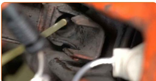
**24** Pritrdite konektor senzorja obrabe zavornih ploščic.
