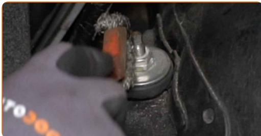
**4** Sprostite zgornje pritrdilne elemente blažilnikov. Uporabite kombinirani ključ №17. Uporabite nasadni ključ za blažilnik št. DD5.2. Uporabite izvijač z zatikalom.
