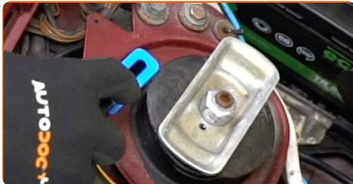
4 Očistite pritrdilni element blažilnika v obliki palice. Uporabite žično krtačo. Uporabite sprej WD-40.
