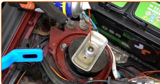
5 Razrahljajte pritrdilne elemente zgornjega nosilca vzetne noge. Uporabite nasadni ključ №13. Uporabite izvijač z zatikalom.
