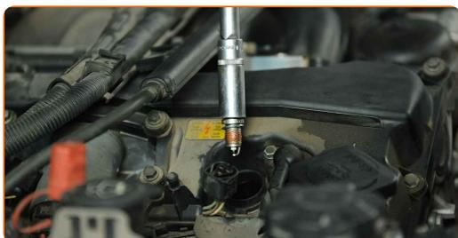
**30** Vstavite nove svečke in jih pričvrstite. Uporabite nastavek ključa za vžigalne svečke št. 16. Uporabite navorni ključ. Zategnite ga do navora 27 Nm.
