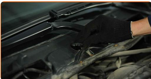
**16** Odvijte pritrdilne elemente diagonalnih letev. Uporabite nasadni ključ N°E18. Uporabite izvijač z zatikalom.
