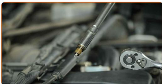
**28** Nanesite tanek sloj posebnega visokotemperaturnega maziva proti zatikanju na navoje novih vžigalnih svečk.
