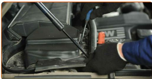
**5** Odstranite električno vezje zgornjega dela ohišja mikrofiltra.
