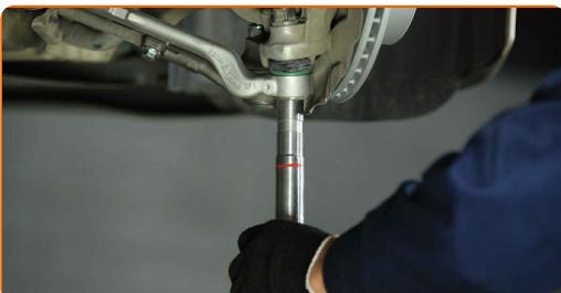
**21** Zategnite zadnji pritrdilni element upravljalnega vzvoda. Uporabite kombinirani ključ №18 (2 kosa). Uporabite navorni ključ. Zategnite ga do navora 68 Nm.+90°
