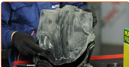
**16** Privijte pritrdilne vijake pokrova zračnega filtra. Uporabite vijačni nastavek T25. Uporabite izvijač z zatikalom.
