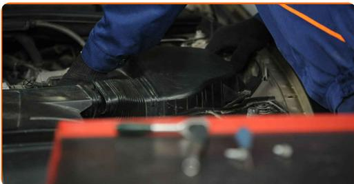
10 Odstranite pritrdilne vijake pokrova zračnega filtra. Uporabite vijačni nastavek T25. Uporabite izvijač z zatikalom.
