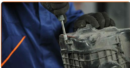
**17** Ponovno namestite ohišje zračnega filtra.
