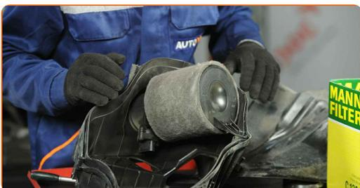
**13** Očistite pokrov zračnega filtra in ohišje.
