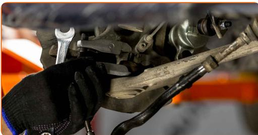
**16** Obdelajte zadrževalni nosilec, ki pritrjuje zavorno cev in snop kablov. Uporabite sprej WD-40.
