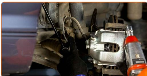
**13** Odvijte žogo skupno pritrditev na volanskem členek. Uporabite nasadni ključ №19. Uporabite izvijač z zatikalom.
