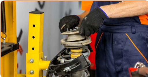
42 Zategnite matico amortizerja. Uporabite nasadni ključ №22. Uporabite imbus št. H6. Uporabite navorni ključ. Zategnite ga do navora 64 Nm.
