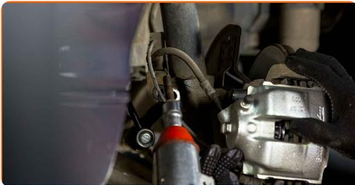
**14** Odklopite napeljavo ABS senzorja.
