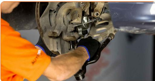
**17** Z opornika odvijte nosilec zavorne cevi. Uporabite nasadni ključ №18. Uporabite izvijač z zatikalom.
