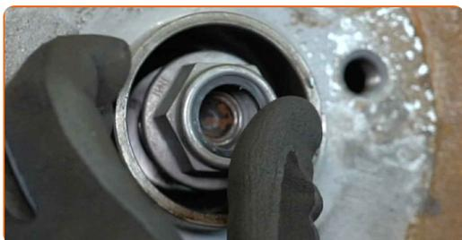
**18** Zategnite pritrdilni element pesta. Uporabite nasadni ključ №30. Uporabite navorni ključ. Zategnite ga do navora 175 Nm.
