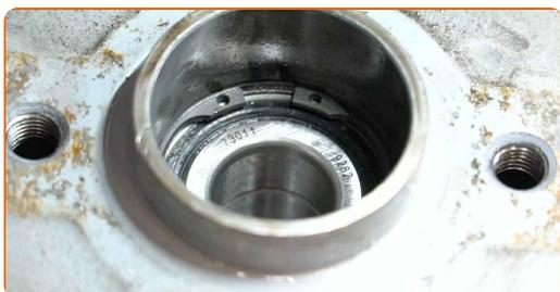
**15** Očistite nosilec ležaja pesta. Uporabite večnamenski čistilni sprej.
