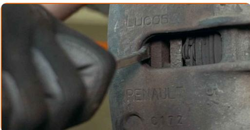
**10** Odvijte pritrditve nosilec čeljusti. Uporabite nasadni ključ №18. Uporabite izvijač z zatikalom.
