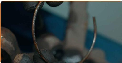
**33** Potisnite ven notranji obroč ležaja, ki je ostal na pestu. Uporabite separator ležaja. Uporabite komplet puše in ležaja gonilnika.
