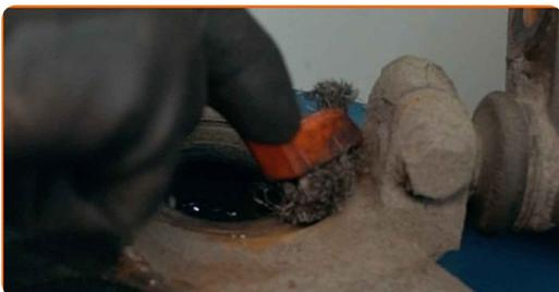
**32** Odstranite zadrževalni obroč ležaja pesta kolesa. Uporabite ploščat izvijač.
