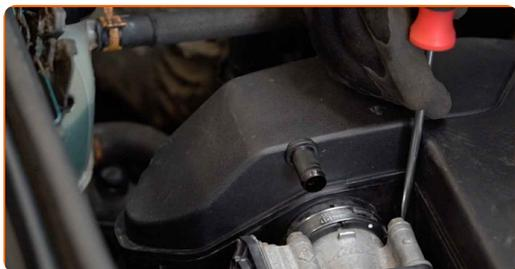
**5** Odstranite ohišje zračnega filtra.
