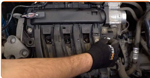
**13** Vstavite nove svečke in jih pričvrstite. Uporabite nastavek ključa za vžigalne svečke št. 16. Uporabite navorni ključ. Zategnite ga do navora 25 Nm.
