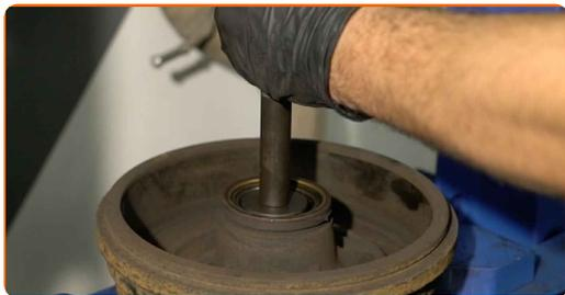
**13** Očistite nosilec ležaja pesta. Uporabite sprej WD-40.
