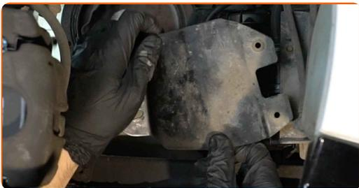
**11** Odvijte vijake nosilca filtra za zrak. Uporabite kombinirani ključ №10.
