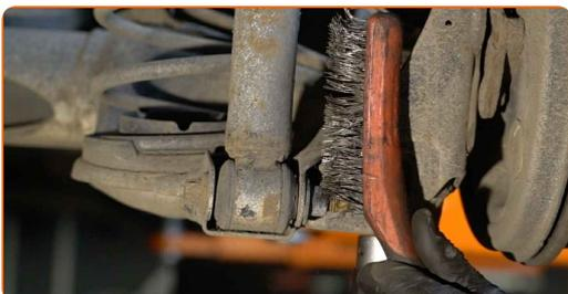
**8** Odvijte spodnjo pritrditev amortizerja. Uporabite nasadni ključ №E18. Uporabite udarni nasadni ključ.
