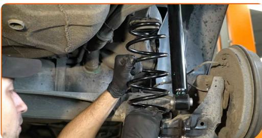
**20** Podprite zadnji nosilec vzmetenja. Uporabite dvigalko s hidravličnim prenosom.
