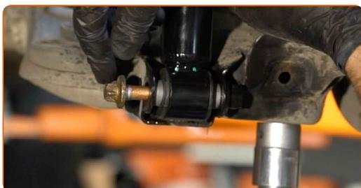
**29** Privijte spodnji pritrdilni element amortizer. Uporabite nasadni ključ N°E18. Uporabite izvijač z zatikalom.
