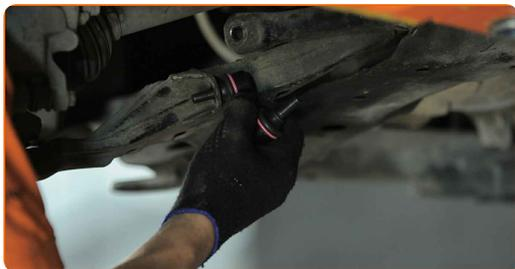
**12** Namestite pritrditev palice na stabilizator in ga zategnite. Uporabite kombinirani ključ №14. Uporabite imbus št. H6. Uporabite navorni ključ. Zategnite ga do navora 39 Nm.
