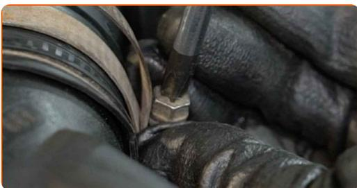
**12** Obdelajte konektor senzorja masnega pretoka zraka. Uporabite dielektrično mast.
