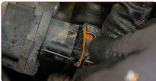
**4** Sprostite pritrdilno objemko, ki povezuje zračni kanal na ohišje zračnega filtra. Uporabite Phillips križni izvijač.
