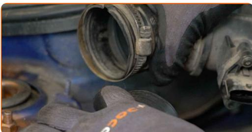
**6** Sprostite sponke, ki pritrjujejo senzor masnega pretoka zraka na zračne cevi. Uporabite ploščat izvijač.
