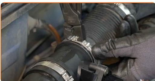
**11** Privijte pritrdilno objemko, ki povezuje zračni kanal z ohišjem zračnega filtra. Uporabite Phillips križni izvijač.
