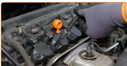
**18** Konektorje vžigalnih tuljav obdelajte s sprejem za čiščenje električnih kontaktov
