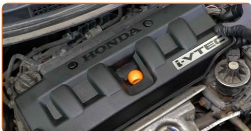
**21** Privijte pritrdilne elemente pokrova motorja. Uporabite ploščat izvijač.
