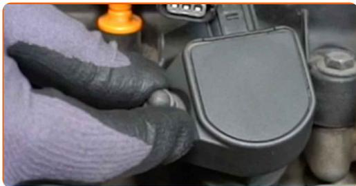
**17** Zategnite pritrditvene elemente vžigalne tuljave. Uporabite nasadni ključ №10. Uporabite navorni ključ. Zategnite ga do navora 9 Nm.
