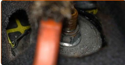
**4** Sprostite zgornje pritrdilne elemente blažilnikov. Uporabite 14-mm nasadni ključ za oporno matico. Uporabite imbus št. H5. Uporabite izvijač z zatikalom.
