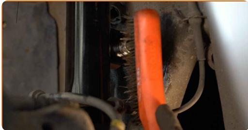
7 Odvijte pritrdilni element, ki povezuje jarmov drog na palico stabilizatorja. Uporabite nasadni ključ №17.
