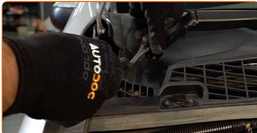
**4** Odvijte pritrdilni element metlic brisalcev vetrobranskega stekla. Uporabite nasadni ključ №14.
