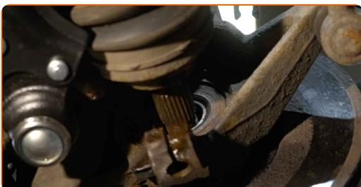
**65** Obdelajte pritrdilni element krogelnega zgloba. Uporabite bakreno mast.
