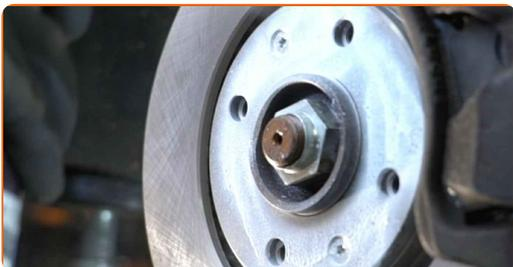
**83** Očistite površino zavornih kolutov. Uporabite čistilo zavor.
