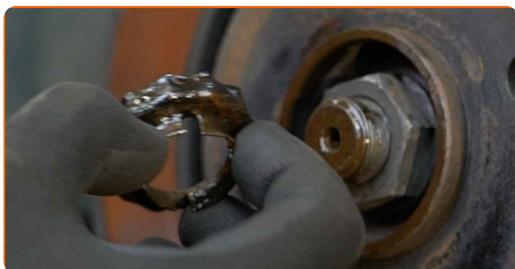
**19** Odvijte pritrdilni element pogonske gredi na pesto kolesa. Uporabite nasadni ključ №36. Uporabite udarni nasadni ključ.
