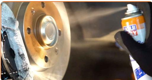
**18** Očistite površino zavornih kolutov. Uporabite čistilo zavor.
