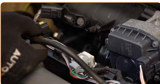
**4** Odklopite cev ventilatorja bloka motorja iz sesalnega kolektorja.
