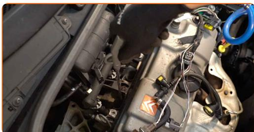
**14** Odvijte vžigalne svečke. Uporabite nastavek ključa za vžigalne svečke št. 16. Uporabite izvijač z zatikalom.
