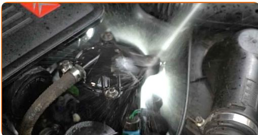
**4** Odvijte pritrtilne elemente pokrova filtra za gorivo. Uporabite imbus št. H4. Uporabite izvijač z zatikalom.
