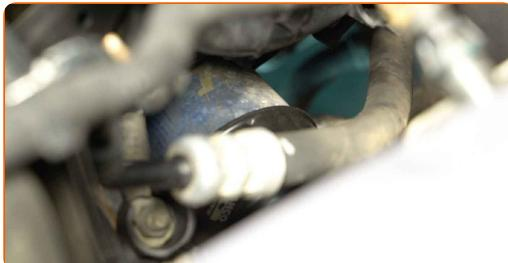
**5** Pripravite posodo za stari oljni filter. Odložite stari oljni filter v posodo.
